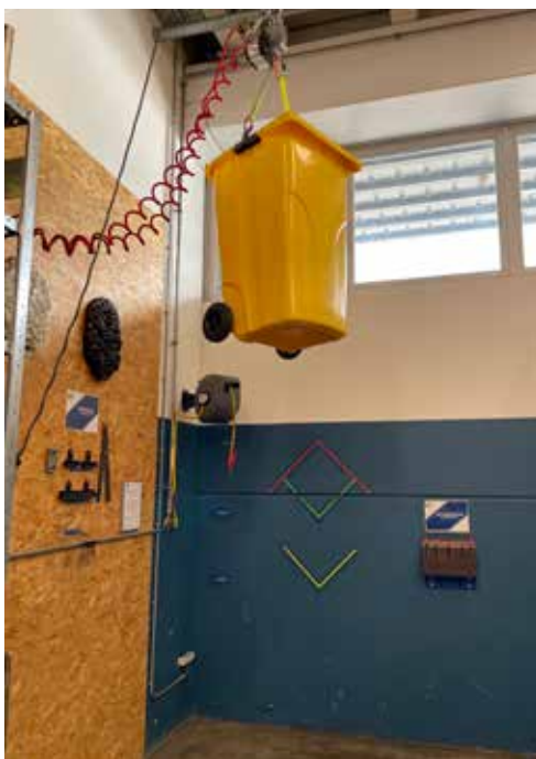
Labor – Falltest eines 2-Radbehälters nach RAL / Laboratory drop test according to RAL of a two- wheeled Bin
